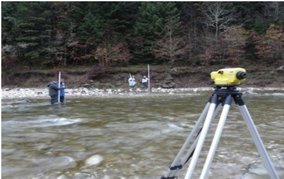
Εικόνα 4.2 Τοπογραφική αποτύπωση με χρήση ειδικού τοπογραφικού εξοπλισμού. Τοπογραφικό GPS (επάνω εικόνα), χωροβάτης και σταδία (κάτω εικόνα)
